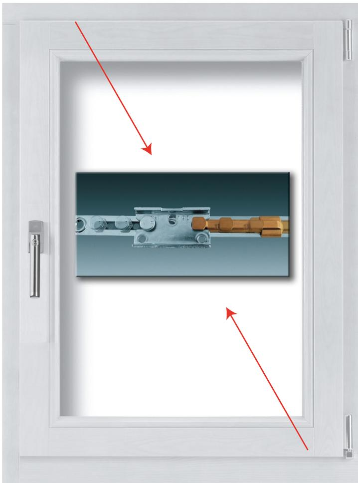
Bei üblichen Fensterkonstruktionen bewegt sich die Verriegelung des Beschlags beim Schließen des Fensters in eine Richtung. Die 2-fach diagonal eingebauten **sis**-Schieber laufen gegeneinander und „verzahnen“ sich. Damit ist der Flügel nicht mehr zu bewegen.
